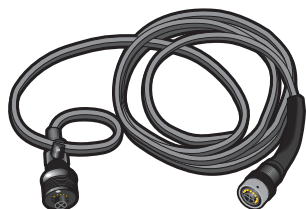
Prodlužovací kabel se smyčkou pro nářadí Tensor S. Díky uspořádání ve smyčce poskytuje kabel vyšší ohebnost, jestliže se nářadí při použití pohybuje po kruhových drahách s malým poloměrem.
