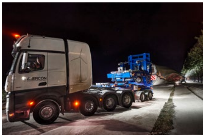
La última fase de 800 metros marcha atrás se completó con total seguridad gracias a la sincronización entre conductor y sistema de dirección trasero.
