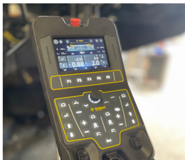
Panneau latéral de la table avec grand écran graphique (A-PAVE/A-PAVE+) pour un accès direct à toutes les fonctions clés.
