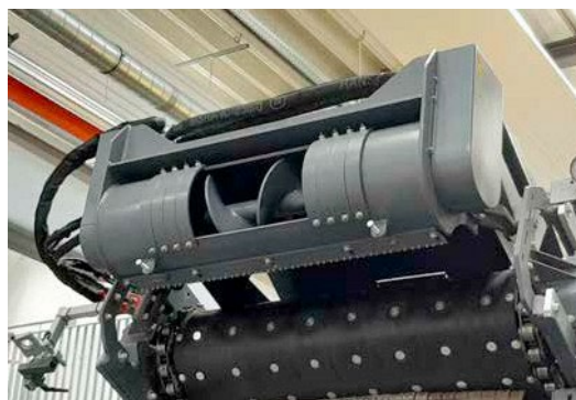
Uso flexible, la unidad de mezcla FLEXMIX se puede plegar hidráulicamente.
