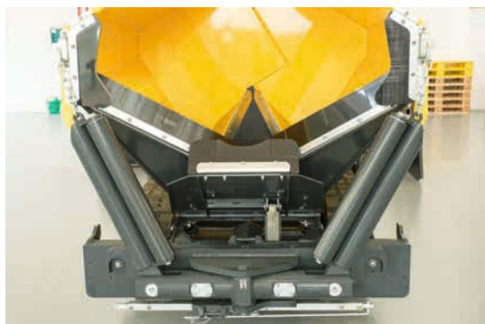
Compuertas delanteras hidráulicas – para un flujo de material limpio.
