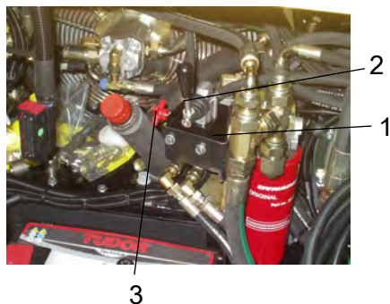
Fig. Soupape pour neutraliser les freins 1. Soupape 2. Bras de pompe 3. Bouton
