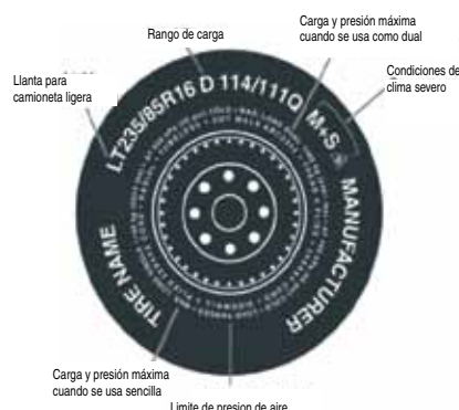
Figura J. Información de la llanta UTQGS
