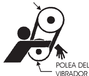
Figura 33. Riesgos con la banda-V
