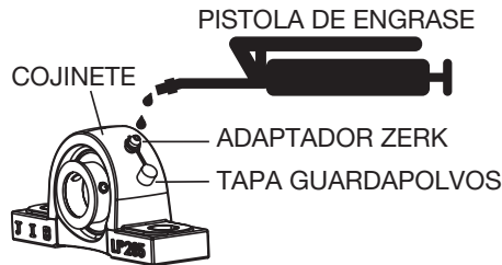
Figura 12. Lubricación del cojinete
