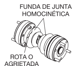
Figura 17. Inspección de las fundas de junta homocinética
