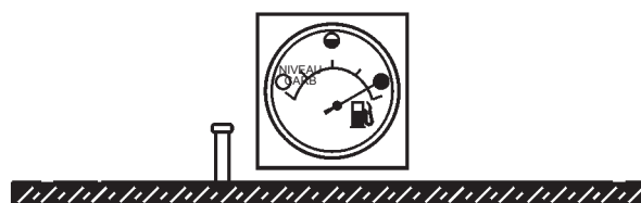
Figure 36. Réservoir de carburant plein
