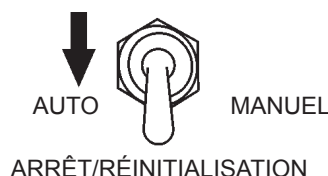
Figure 59. Commutateur de commande MEPC (Arrêt/Réinitialisation)
