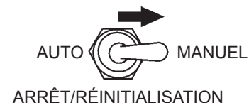
Figure 44. Commutateur de commande MPEC (Position manuelle)
