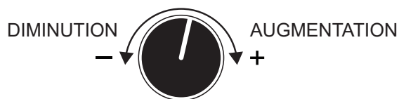
Figure 11. Régulateur de tension
