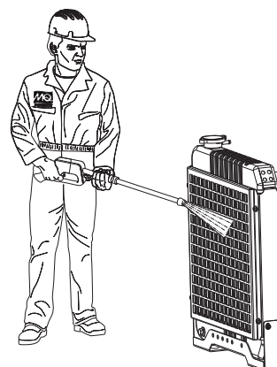
Figure 54. Nettoyage des radiateurs
