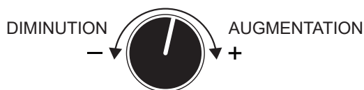
Figure 37. Régulateur de tension
