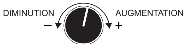
Figure 9. Régulateur de tension
